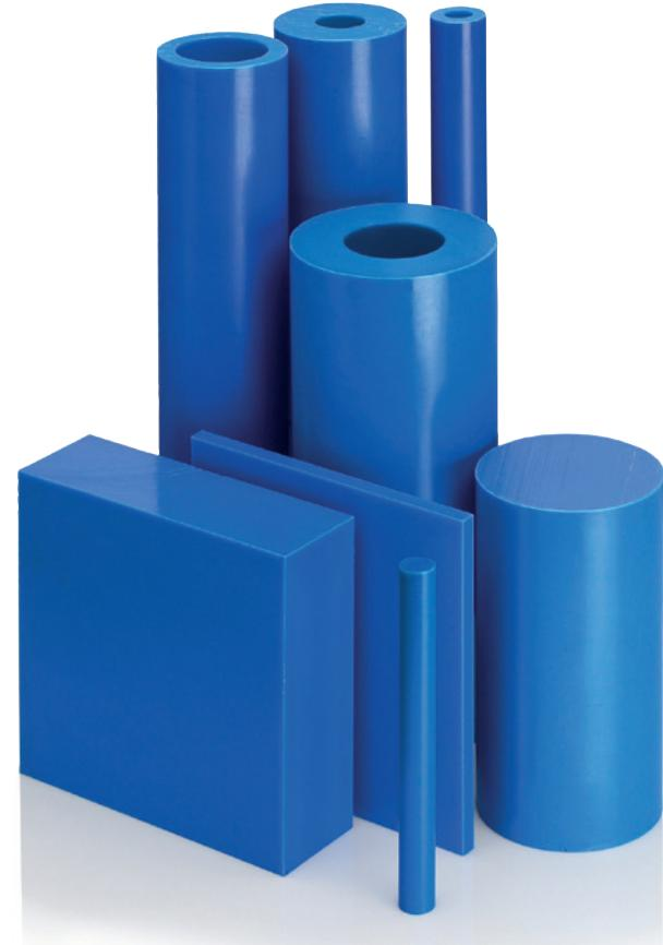
Le **NYCAST® XHA** est un nylon coulé 6 qui possède un additif lui permettant de se stabiliser face aux hautes températures. Le stabilisateur de chaleur retarde la perte de propriétés physiques lorsque la température augmente. Cela permet donc au matériau de fonctionner à des températures environ 10 % plus élevées que les grades standard.
